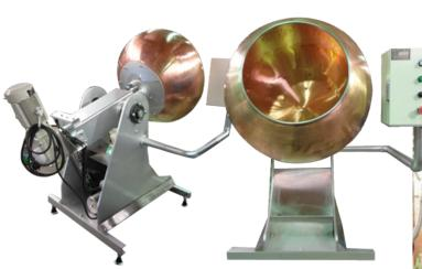
工場内で稼働中のコーティングマシン(通商レボパ ンとかドラ/製品をドラジェDragee、加工機をドラ ジェマシンとも言われる) 加工製品によって形状、 容量、角度、回転数など最適の条件が求められる。
